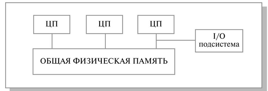
Рис. 3.1. Схематический вид SMP-архитектуры
