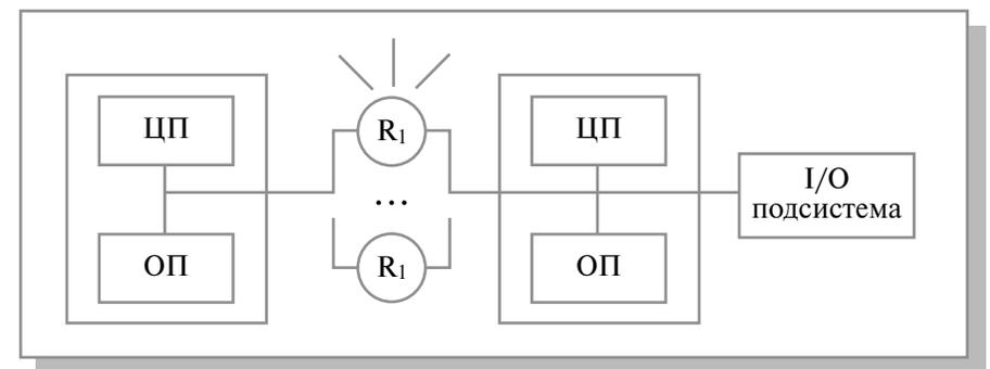
Рис. 3.2. Схематический вид архитектуры с разделяемой памятью
