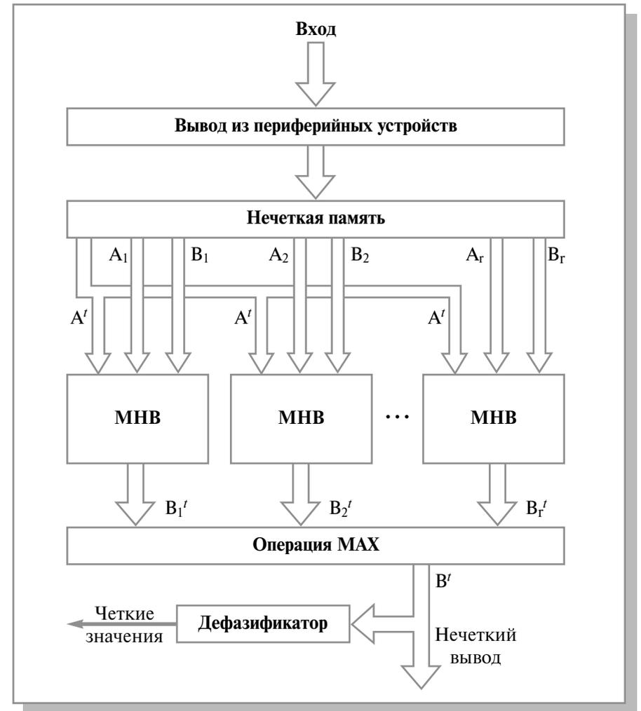
Рис. 8.4. Архитектура нечеткого компьютера (МНВ – механизм нечеткого вывода)
