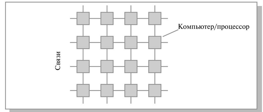
Рис. 4.3. Схема соединения процессоров в виде плоской решетки
