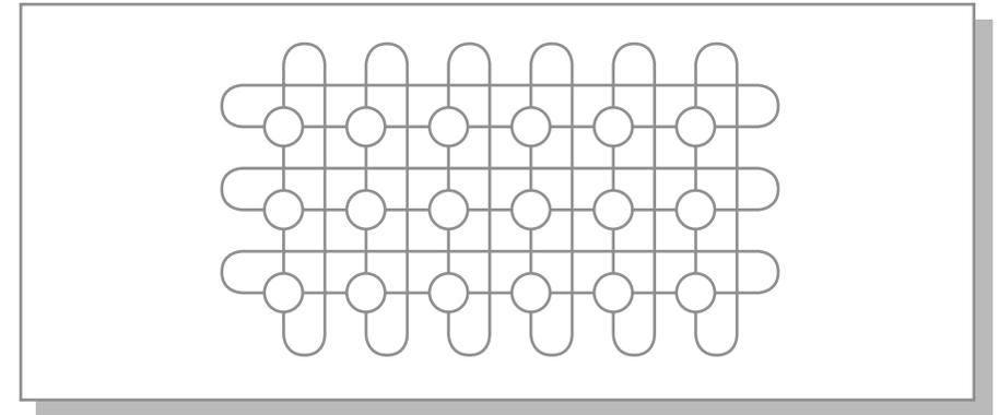
Рис. 5.1. Матрица узлов кластера на основе сети SCI
