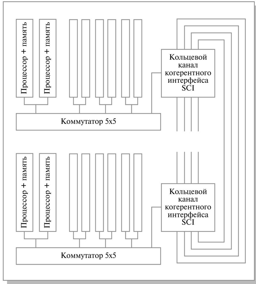
Рис. 10.2. Граф межмодульных связей Convex Exemplar SPP1000
