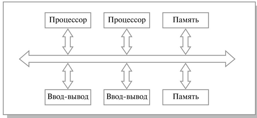
**Рис. 9.1.** Общая схема шинной структуры
