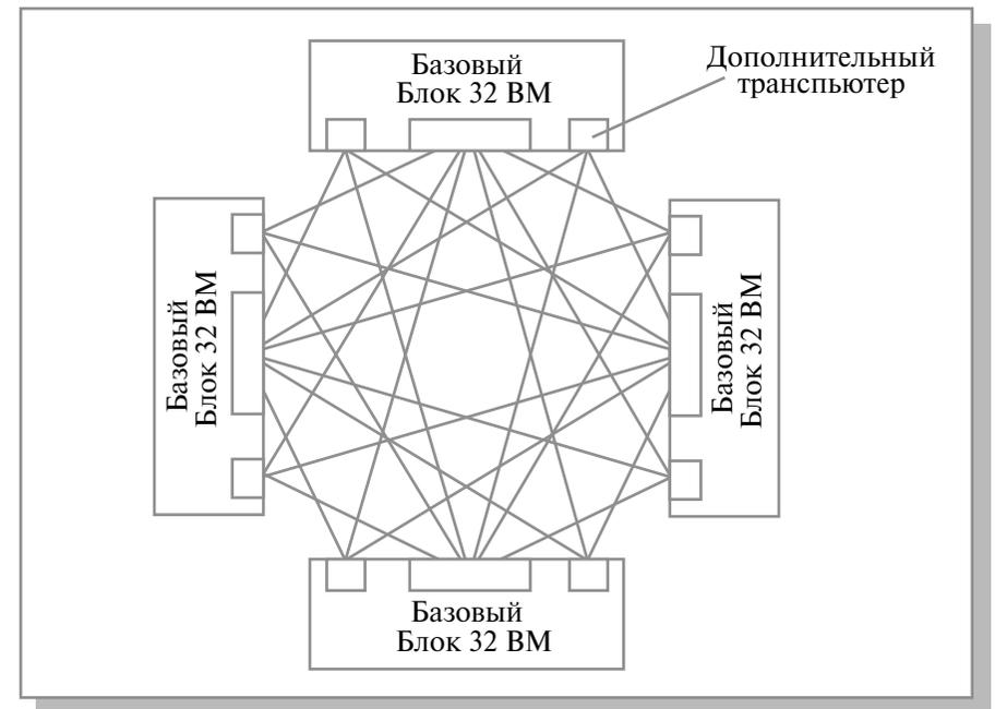
Рис. 10.5. Структура 128-процессорной системы MVS-1000, 4 базовых блока
