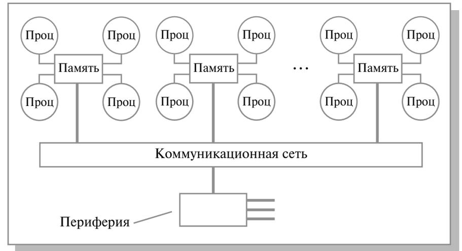
Рис. 3.3. Структурная схема компьютера с гибридной сетью
